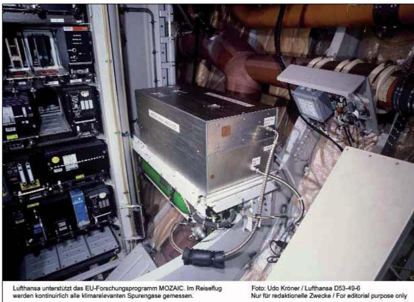
Lufthansa unterstützt das EU-Forschungsprogramm MOZAIC. Im Reiseflug werden kontinuierlich alle klimarelevanten Spurengase gemessen.
